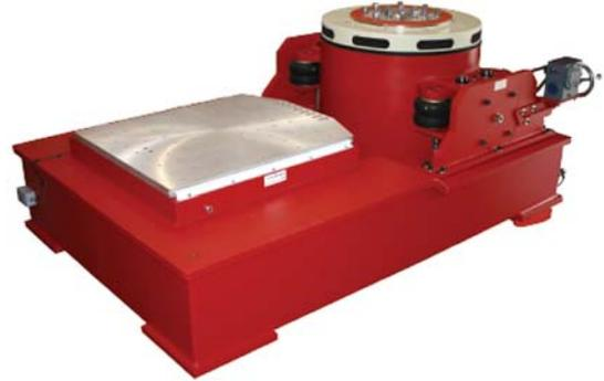
图 3 美国迪飞 电磁振动台
